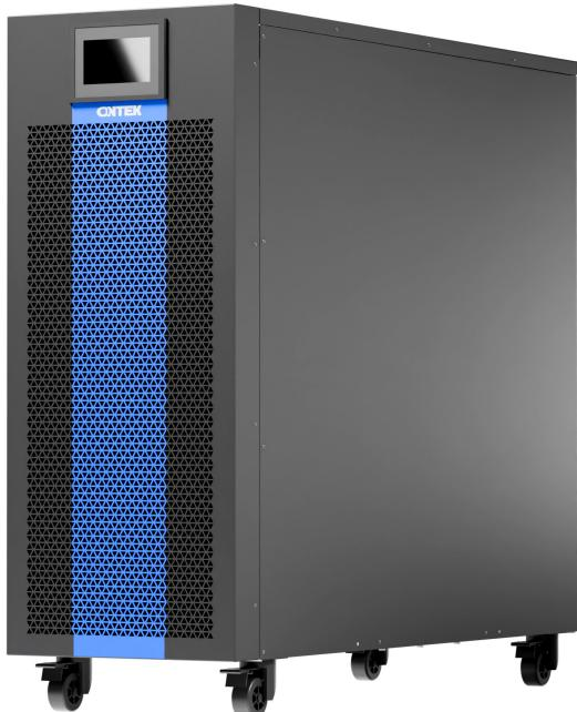
ИБП ONTEK PM40TR мощностью 40кВА/40кВт для работы с внешними батареями. Два раздельных ввода: основной ввод и линия байпаса. 4 встроенных переключателя: основной вход, выход, вход статического байпаса, механический байпас. Параллельная работа до 8 ИБП.
