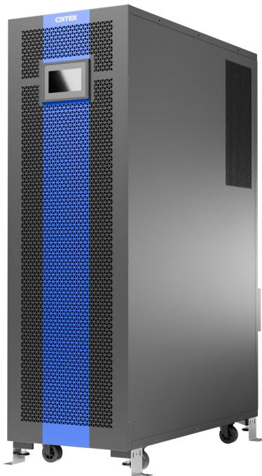
ИБП ONTEK PM15SBTR / 200 L5 мощностью 15кВА/15кВт укомплектован 200 батареями со сроком службы 5 лет. Два раздельных ввода: основной ввод и линия байпаса. 4 встроенных переключателя: основной вход, выход, вход статического байпаса, механический байпас. Параллельная работа до 8 ИБП.
