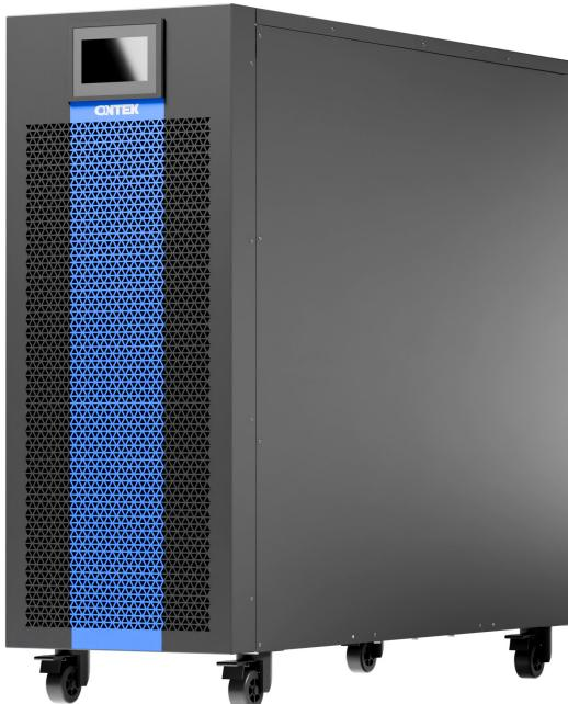
ИБП ONTEK PM15SBTR / 128 L5 мощностью 15кВА/15кВт укомплектован 128 батареями со сроком службы 5 лет. Два раздельных ввода: основной ввод и линия байпаса. 4 встроенных переключателя: основной вход, выход, вход статического байпаса, механический байпас. Параллельная работа до 8 ИБП.
