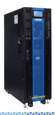
ИБП ONTEK TM ISO 100 мощностью  $100 \kappa BA/\kappa BT$ . PF = 1. Встроенный выходной изолирующий трансформатор. 4 встроенных переключателя: сетевой вход, вход байпаса, выход, сервисный байпас.
