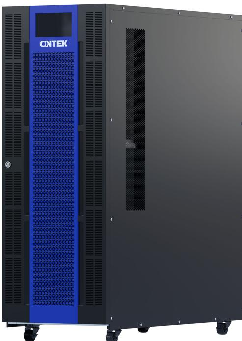
ИБП ONTEK TM180 мощностью 180кВА/кВт. PF = 1. Силовые модули с горячей заменой и фильтром защиты от пыли. Параллельная работа до 8 ИБП от общей батарейной ёмкости. Встроенный 7-дюймовый сенсорный экран с комплексной информацией. Два раздельных ввода: основной ввод и линия байпаса.
