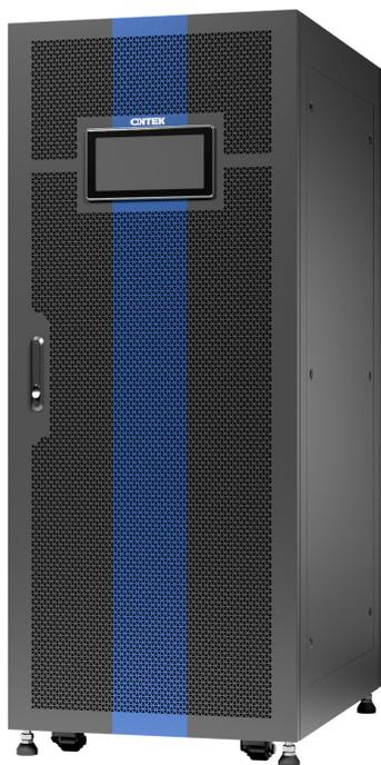
ИБП ONTEK TM160 мощностью 160кВА/кВт. PF = 1. Силовые модули с горячей заменой и фильтром защиты от пыли. Параллельная работа до 8 ИБП от общей батарейной ёмкости. Встроенный 7-дюймовый сенсорный экран с комплексной информацией. Два отдельных ввода: основной ввод и линия байпаса.
