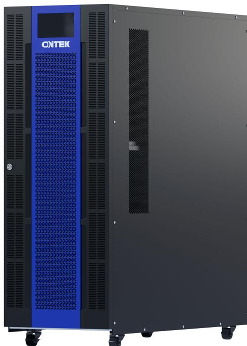
ИБП ONTEK TM100 мощностью 100кВА/кВт. PF = 1. Силовые модули с горячей заменой и фильтром защиты от пыли. Параллельная работа до 8 ИБП от общей батарейной ёмкости. Встроенный 7-дюймовый сенсорный экран с комплексной информацией. 3 встроенныхых переключателя: основной вход, выход, механический байпас.
