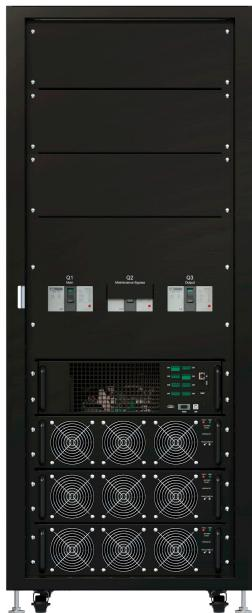
ИБП ONTEK SPM90 SPM9030U120SB303W0 - модульная конструкция, силовые модули 30 кВА/кВт, установлены 3 модуля. Внешние батареи. Регулируемый пользователем зарядный ток.
