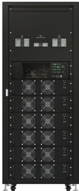
ИБП ONTEK SPM120 SPM12030U120SB206W0 - модульная конструкция (силовые модули 20 кВА/кВт). До 6 модулей на шкаф. Модульная конструкция снижает MTTR. Параллельное резервирование N+1 или N+X для гарантии надежности. Простота установки и обслуживания. Внешние батареи.
