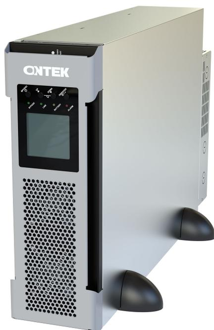
ИБП ONTEK Power 10кВА/10кВт 3фазы/1фаза. Двойное преобразование. Коэффициент выходной мощности PF=1. Трансформируемая конструкция стойка/башня, высота 3U. Специальная соединительная коробка для горячей замены. Параллельная работа с общей батарейной ёмкостью. Совместимость с генераторами. Возможность создать индивидуальную систему питания.
