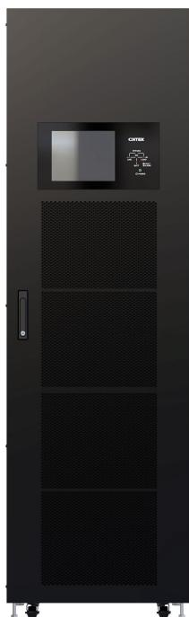
ИБП ONTEK MPM420 - высокоэффективный модульный ИБП. Силовые модули 60 кВА/кВт размером 3U. До 7 модулей на шкаф. Модульная конструкция с горячей заменой снижает среднее время восстановления (MTTR). 10-дюймовый цветной сенсорный ЖК-экран.
