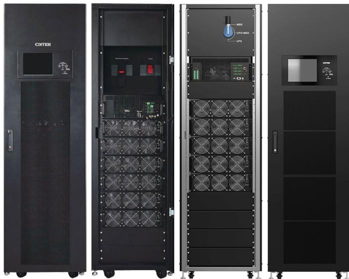
ИБП ONTEK MPM180 - высокоэффективный модульный ИБП. Силовые модули 60 кВА/кВт размером 3U. До 3 модулей на шкаф. Модульная конструкция с горячей заменой снижает среднее время восстановления (MTTR). Резервирование N+1 или N+N.
