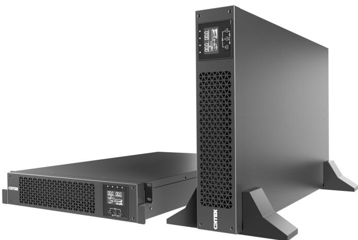
ИБП ONTEK SMXRT 3/10 мощностью 3000 ВА/Вт. PF = 1. Двойное преобразование: чистая синусоида на выходе, время перехода на батареи 0 мс. Установка стойка/башня. Горячая замена батарей. Технология трехступенчатого заряда. Внутренние батареи со сроком службы 10 лет.
