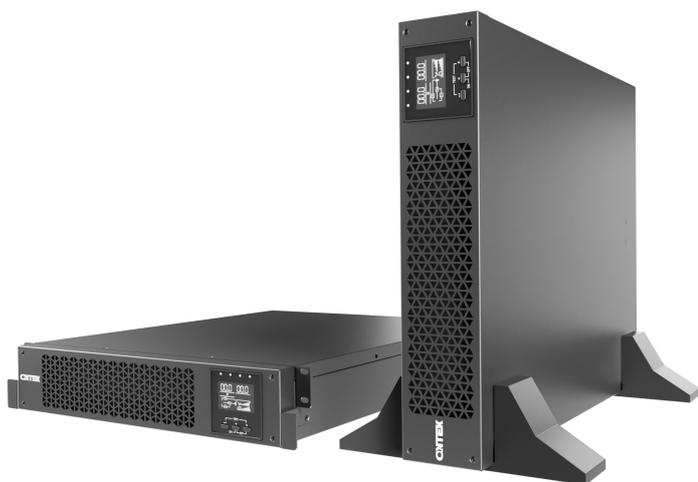
ИБП ONTEK SMXRT 2 мощностью 2000 ВА/Вт. PF = 1. Двойное преобразование: чистая синусоида на выходе, время перехода на батареи 0 мс. Установка стойка/башня. Горячая замена батарей. Технология трехступенчатого заряда. Внутренние батареи со сроком службы 5 лет.
