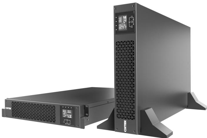
ИБП ONTEK SM RT 6 V2 мощностью 6000 ВА/Вт. PF = 1. Двойное преобразование: чистая синусоида на выходе, время перехода на батареи 0 мс. Установка стойка/башня. Предназначен для работы с внешними батареями. Технология DSP гарантирует высокую производительность.
