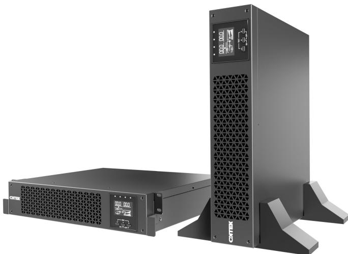
ИБП ONTEK SMRT 3 /wo V2 мощностью 3000 ВА/Вт, версия 2. Двойное преобразование: чистая синусоида на выходе, время перехода на батареи 0 мс. Установка стойка/башня. Горячая замена батарей. Технология трехступенчатого заряда. Для работы с внешними батареями.
