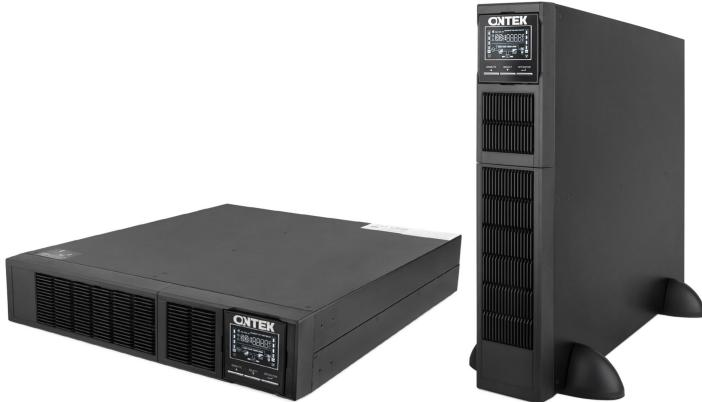
ИБП ONTEK SMRT2SBUL10 мощностью 2000 ВА/Вт. PF = 1. Внутренние батареи. Горячая замена батарей. Двойное преобразование: чистая синусоида на выходе, время перехода на батареи 0 мс. Установка стойка/башня. Программируемые розетки управления питанием. Установлены батареи со сроком службы 10 лет.
