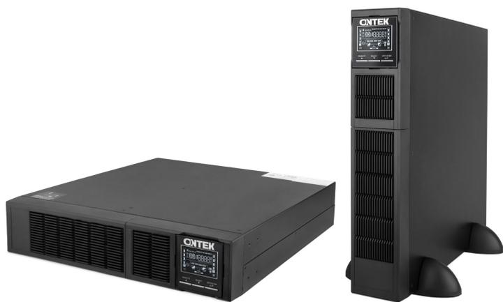
ИБП ONTEK SMRT1SBUL10 мощностью 1000 ВА/Вт. PF = 1. Двойное преобразование: чистая синусоида на выходе, время перехода на батареи 0 мс. Установка стойка/башня. Программируемые розетки управления питанием. Горячая замена батарей. Установлены АКБ со сроком службы 10 лет.
