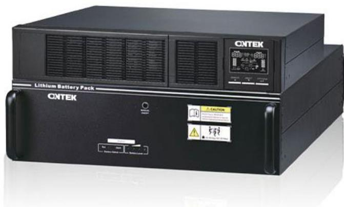
Литий-ионный ИБП ONTEK OLIO6000LWB10 6000ВА и батарейный модуль OLIFBM100 (LiFePO4). Занимает вдвое меньше места и имеет срок службы в 3 раза больше, чем ИБП с батареями VRLA. Трансформируемая конструкция стойка/башня. Модульная конструкция легко расширяется. Система управления батареями (BMS).
