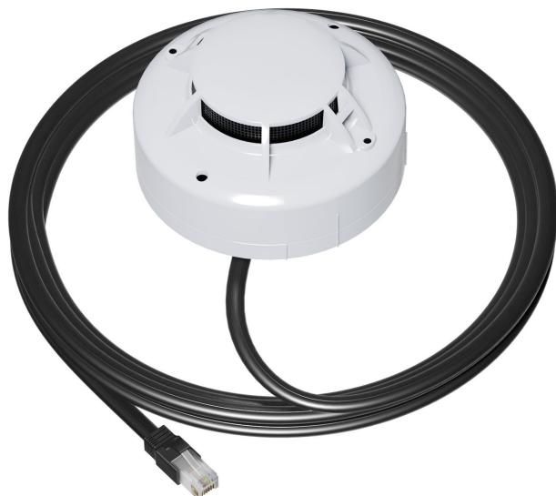
Датчик дыма для панели распределения ONTEK PDU предназначен для раннего выявления возгораний, сопровождающихся образованием дыма, внутри помещений. При достижении опасной концентрации дымовых частиц в воздухе чувствительный элемент датчика изменяет свои электрические параметры (в частности, внутреннее сопротивление). Это изменение фиксируется и преобразуется в сигнал тревоги, который незамедлительно передаётся на систему мониторинга.
