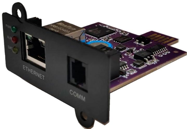
Встраиваемый SNMP-адаптер UN807 для удалённого мониторинга и управления ИБП ONTEK серий SMRT 6-10 (SB), SMX RT, SPM+, PM TR, MPM Plus через локальную сеть или Интернет.
