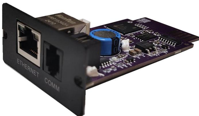
Встраиваемый SNMP-адаптер UN806 для удалённого мониторинга и управления ИБП ONTEK серий SM RT, SM RM, PM, PM Rack, TM, SPM, MPM через локальную сеть или Интернет.
