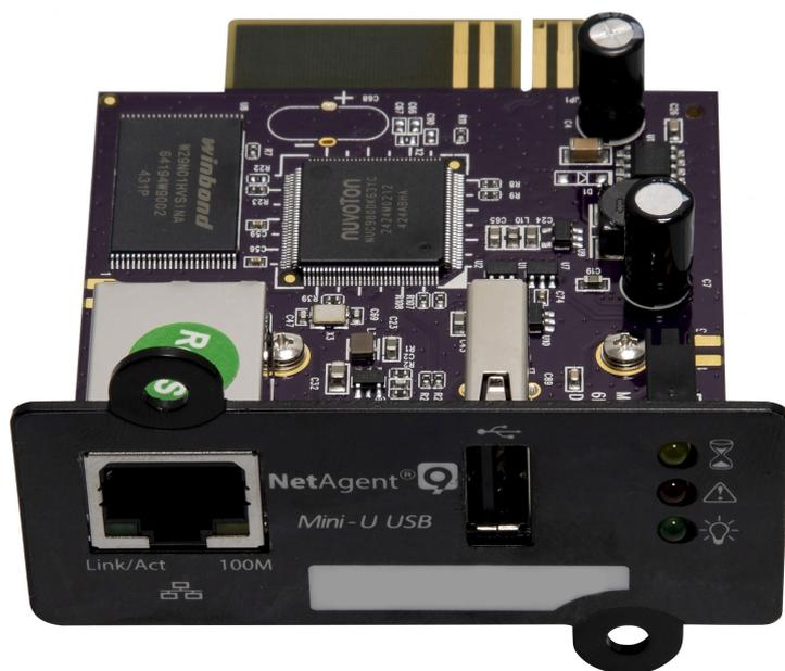
Встраиваемый SNMP-адаптер DS807 для удалённого мониторинга и управления ИБП ONTEK серии SM RT 6 (SB) через локальную сеть или Интернет.
