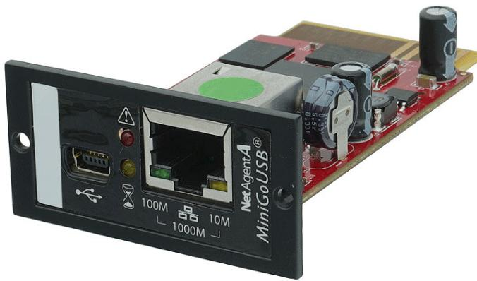
Встраиваемый SNMP-адаптер DA806 для удалённого мониторинга и управления ИБП ONTEK серий SM RT, SM RM, PM, PM Rack, TM, SPM, MPM через локальную сеть или Интернет.
