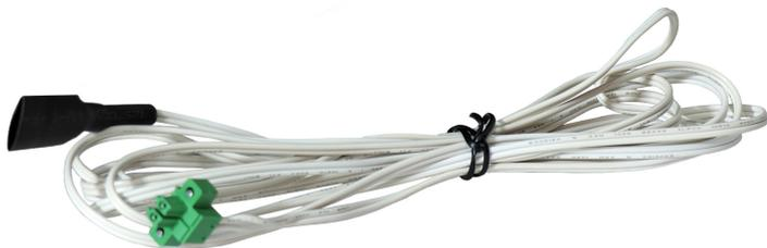
Температурный датчик АКБ контролирует температуру окружающей среды вокруг батарей и передаёт данные о ней в ИБП. Что позволяет зарядному устройству ИБП осуществлять температурную компенсацию заряда АКБ. Температурная компенсация способствует продлению срока службы аккумуляторных батарей.
