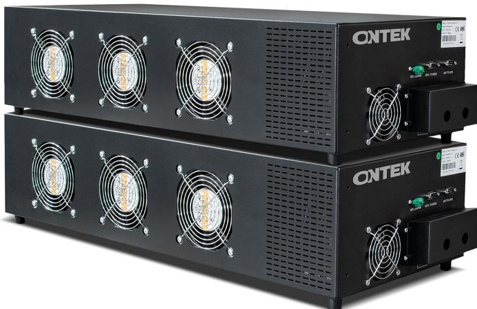
Блок поглощения рекуперативной мощности (БПРМ) ONTEK служит для обеспечения возможности работы ИБП с регенеративной нагрузкой (током рекуперации) во всех режимах (как от сети, так и в батарейном режиме) с мощностью до 12 кВт.
