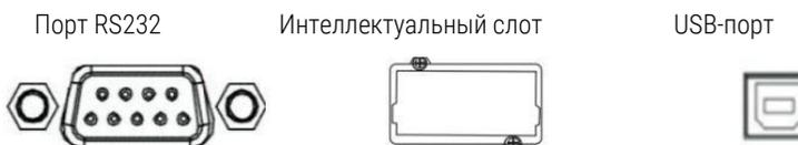
Чтобы обеспечить автоматическое отключение/запуск ИБП и мониторинг состояния, подсоедините кабель связи одним концом к порту USB/RS232, а другим - к порту связи вашего ПК. Установив программное обеспечение для мониторинга, вы можете запланировать выключение / запуск ИБП и отслеживать его состояние с помощью ПК.
