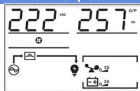
ЖК-дисплей 5: Выходное напряжение и выходная полная мощность
