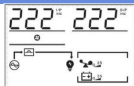
ЖК-дисплей 3: Напряжение и емкость батареи
