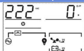
ЖК-дисплей 4: Выходное напряжение и выходная активная мощность
