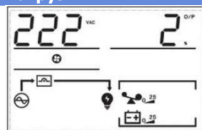
ЖК-дисплей 6: Выходное напряжение и процент нагрузки
