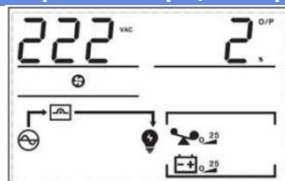
ЖК-дисплей 6: Выходное напряжение и процент нагрузки
