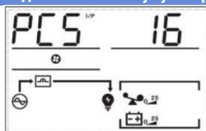
ЖК-дисплей 8: количество подключенных аккумуляторов
