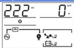
ЖК-дисплей 6: Выходное напряжение и процент нагрузки
