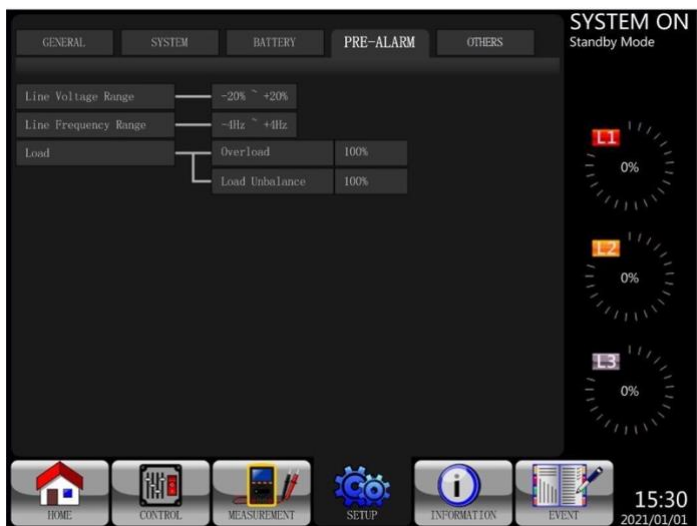
Рисунок 4-18 Настройка-экран предварительной сигнализации
