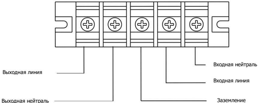
Схема подключения клеммной колодки
