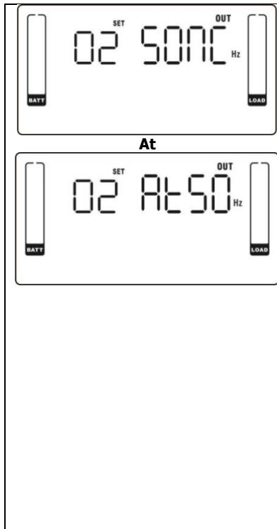
Гц до 64 Гц, то выходная частота будет составлять 60,0 Гц. At - это настройка по умолчанию.
