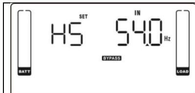
Нажмите клавишу "Enter", чтобы подтвердить установленное значение для нижней точки. Затем отобразится HS в параметре 1. Пожалуйста, установите максимальную точку в параметре 2, нажав клавишу "Вверх" или "Вниз".
