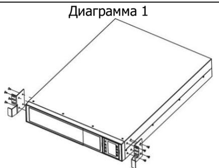
Шаг 2: Поднимите модуль ИБП и вставьте его в корпус стойки. Прикрепите модуль ИБП к стойке с помощью винтов, гаек и шайб (не входят в комплект) через его монтажные проушины к направляющим стойки. Пожалуйста, обратитесь к диаграмме 2.
