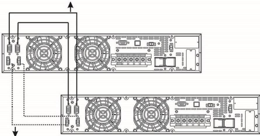
**Диаграмма 2: Электрическая схема параллельной системы**
