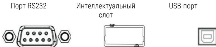
Чтобы обеспечить автоматическое отключение/запуск ИБП и мониторинг состояния, подсоедините кабель связи одним концом к порту USB/RS232, а другим - к порту связи вашего ПК. Установив программное обеспечение для мониторинга, вы можете запланировать выключение / запуск ИБП и отслеживать его состояние с помощью ПК.
