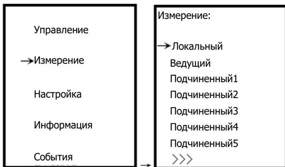
"Локальный" означает текущий модуль ИБП, "Ведущий" и "Подчиненный<n>" означают другой модуль ИБП в этой параллельной системе.
