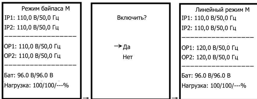
Когда ИБП включен, вы можете нажать кнопку "ВЫКЛ./ESC", чтобы перевести ИБП в режим обхода или ожидания.
