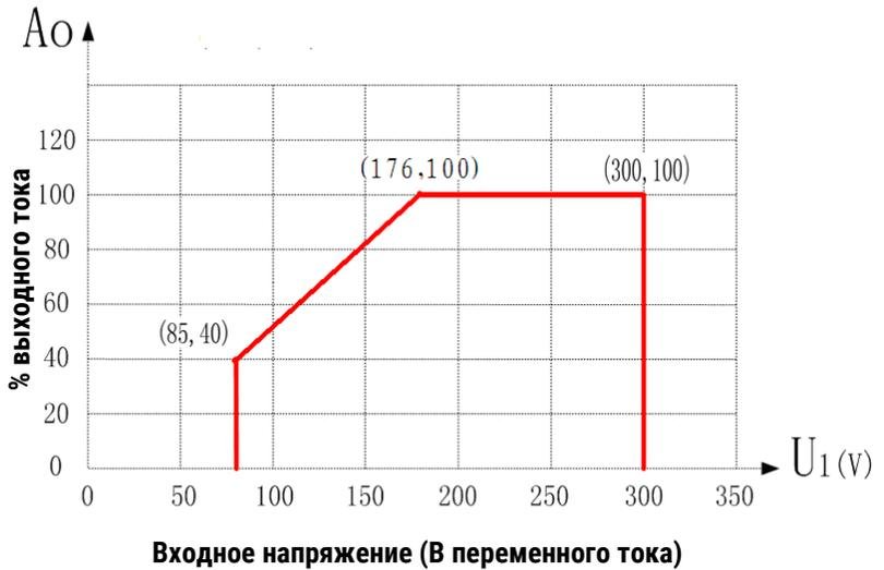
Рис. 2-3 Кривая выходная мощность-входное напряжение
