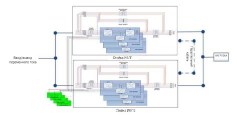
Рисунок 9-1 Подключение параллельной системы с тремя выключателями
