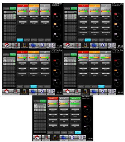
Рис. 4-10 Экраны измерения модуля
