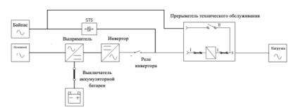
Рисунок 3-8: Схема режима выключения
