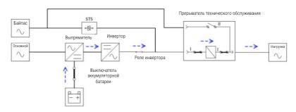
Рисунок 3-5: Схема линейного режима
