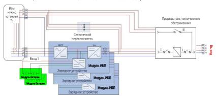
Схема подключения для одного входа с одним байпасным выключателем технического обслуживания
