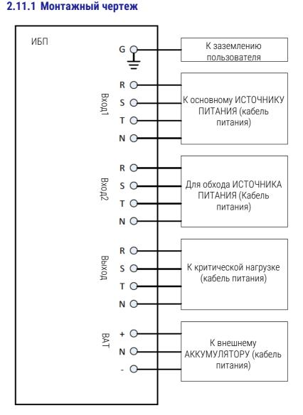
Рисунок 2-17. Подключение шкафа ИБП
