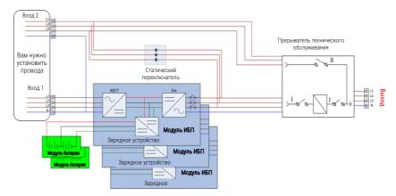
Схема подключения для двух входов с одним байпасным выключателем технического обслуживания
