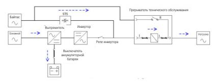
Рисунок 3-6: Схема режима байпаса
