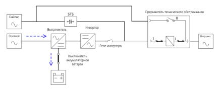
Рисунок 3-3: Схема режима ожидания
