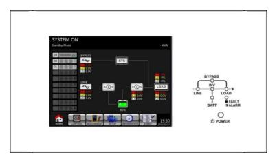
**Шаг 4:** Прежде чем ИБП перейдет в режим выключения, пожалуйста, нажмите кнопку "ПИТАНИЕ" в течение 2 секунд, как показано на схеме ниже.
