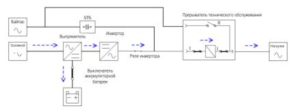
Рисунок 3-4: Схема линейного режима
