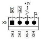
Рисунок 5-4 Порт определения температуры батарейного отсека
