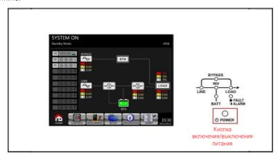
**Шаг 5:** Затем ИБП перейдет в режим работы от батареи, как показано на схеме ниже.
