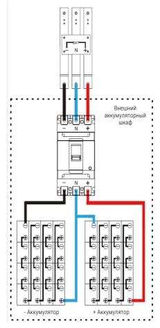
Рисунок 2-18. Подключение внешнего батарейного шкафа
