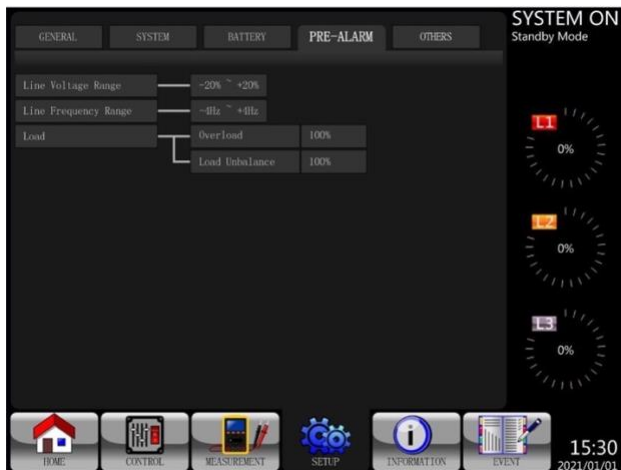
Рисунок 4-18 Настройка-экран предварительной сигнализации
