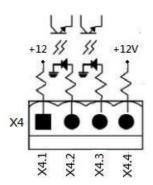
Рисунок 5-3 Порт состояния байпасного переключателя технического обслуживания
