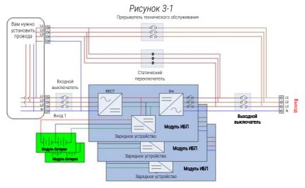
Схема подключения для одного входа с тремя выключателями
