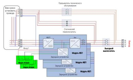
Электрическая схема для одного входа с двумя выключателями
