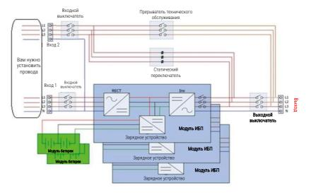
Схема подключения для двух входов с тремя выключателями
