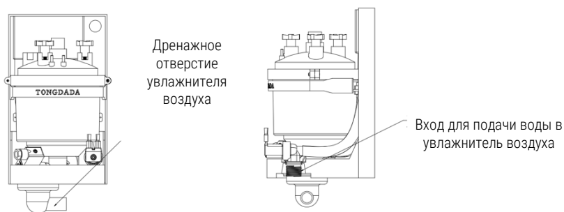
Рис. 3-9 Труба подачи увлажняющей воды
