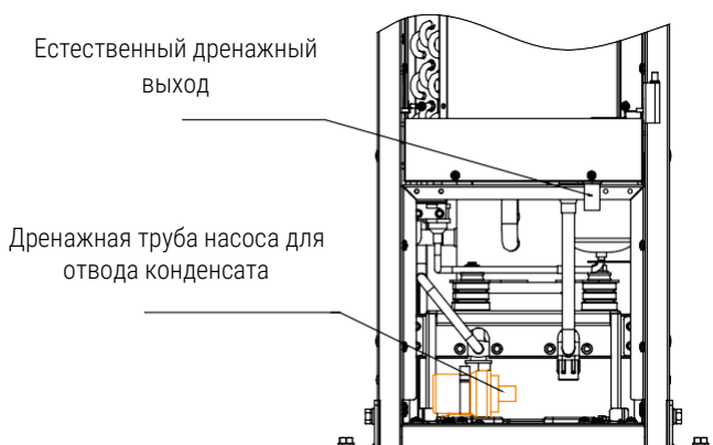
Рис. 3-8 Принципиальная схема положения стыка дренажных труб
