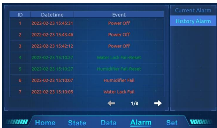
Рис. 4-9 Принципиальная схема текущего и исторического сигналов тревоги
