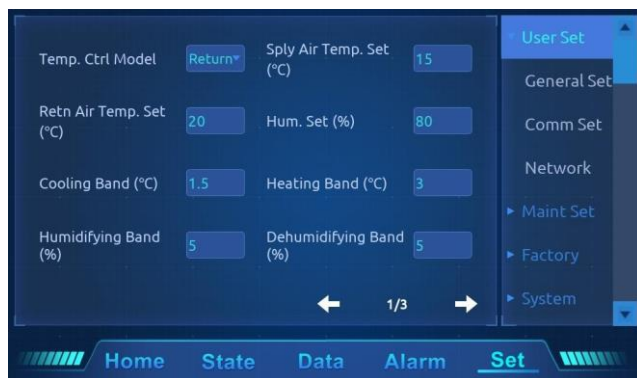
Рис. 4-11 Принципиальная схема интерфейса системных настроек
