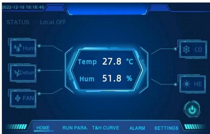
Рис. 4-1 Принципиальная схема основного интерфейса экрана дисплея
