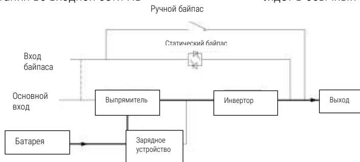
Рисунок 1-3 Схема работы в режиме работы от батареи
