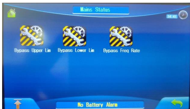
Страница настройки байпаса
